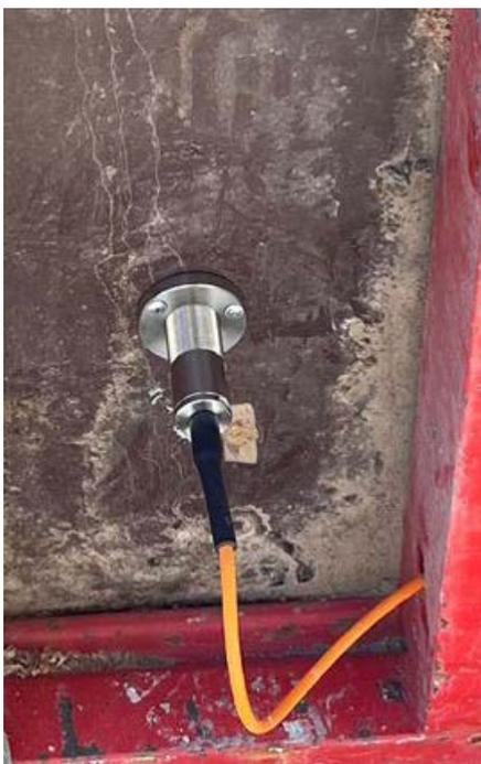
Благодаря измерению давления на опалубку может быть определена и оптимизирована скорость бетонирования.
